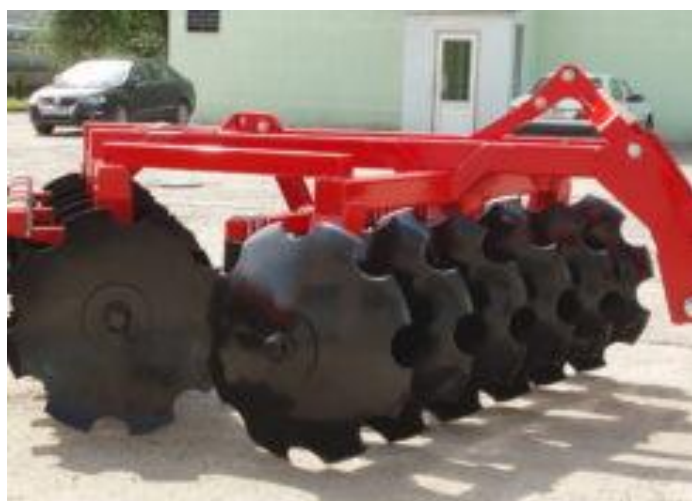
Рисунок 1. Борона дисковая навесная мелиоративная БДН-3А. Вид спереди справа
