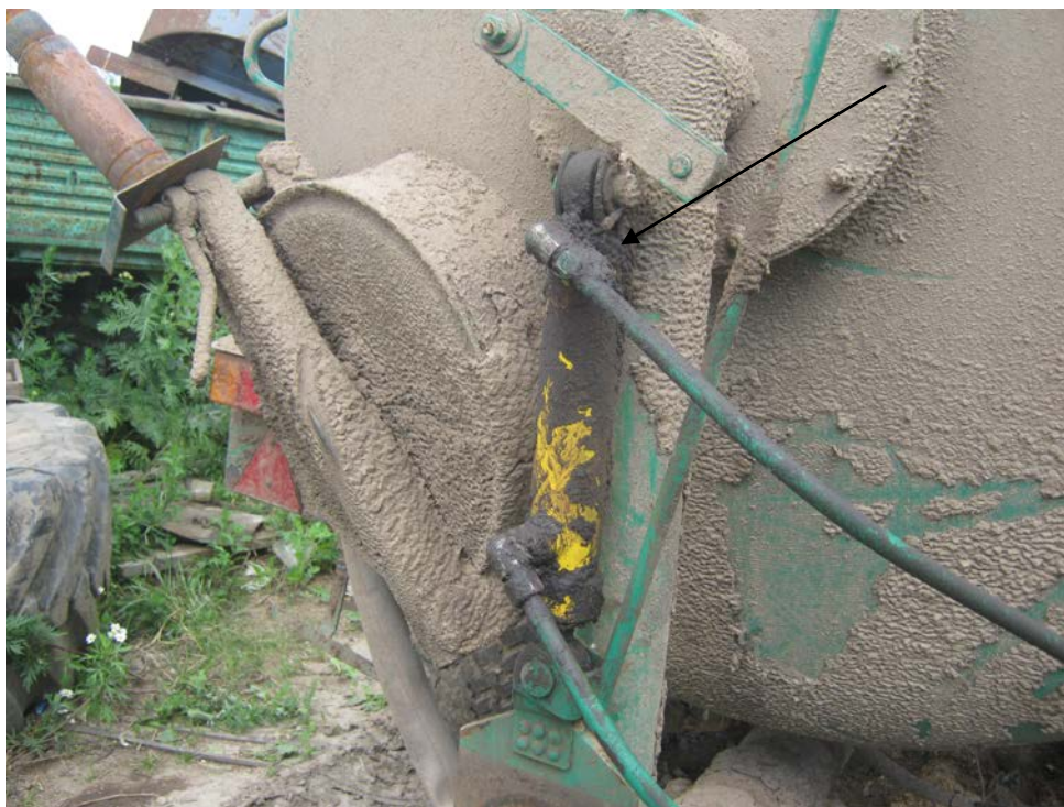
Рис. А.1- Машина для внесения жидких органических удобрений МЖТ-Ф-11 Утечка рабочей жидкости через уплотнения гидроцилиндра
