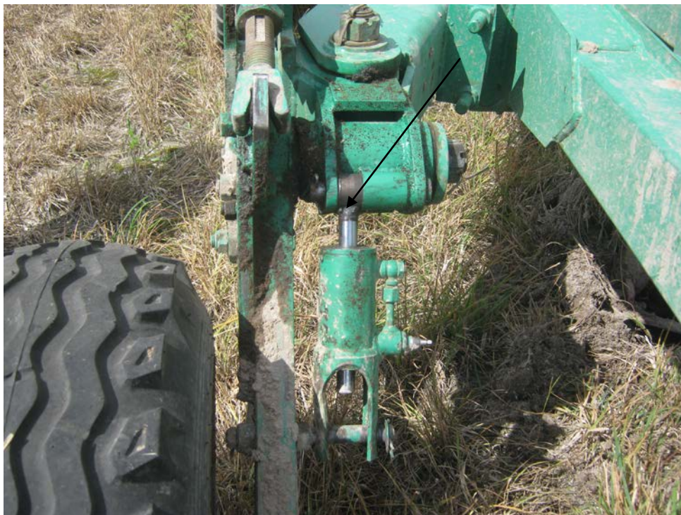
Рис. А.5 - Плуг оборотный ППО-8-40-01. Электросварка, вид после устранения отказа
