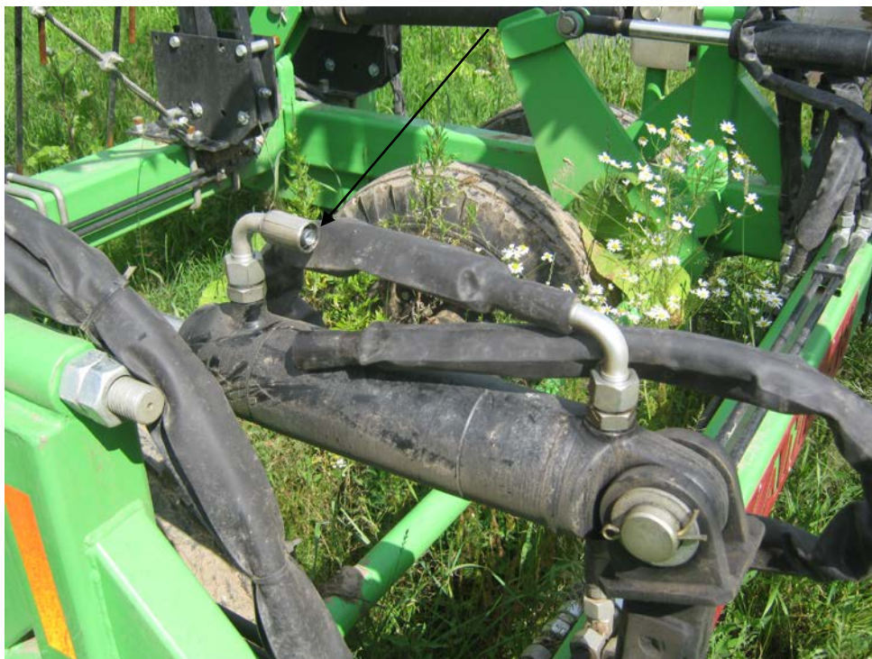
Рис. А.4 - Тяжелая стерневая борона КАМА-18. Вырыв шланга из заделки
