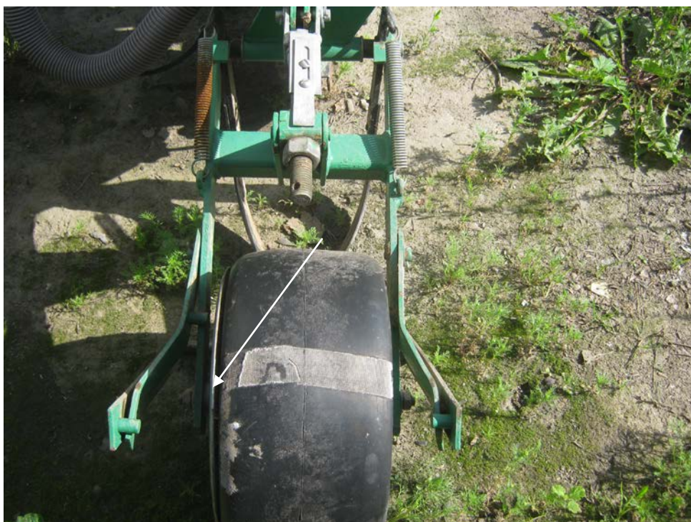
Рис. А.2 - Сеялка пропашная блочносоставляемая МС-8. Сползание резино- вого бандажа с обода.
