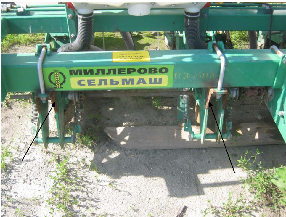
Рис. А.3 - Сеялка пропашная блочно-составляемая МС-8. Установка дополнительных косынок при помощи электросварки. Вид после устранения отказа
