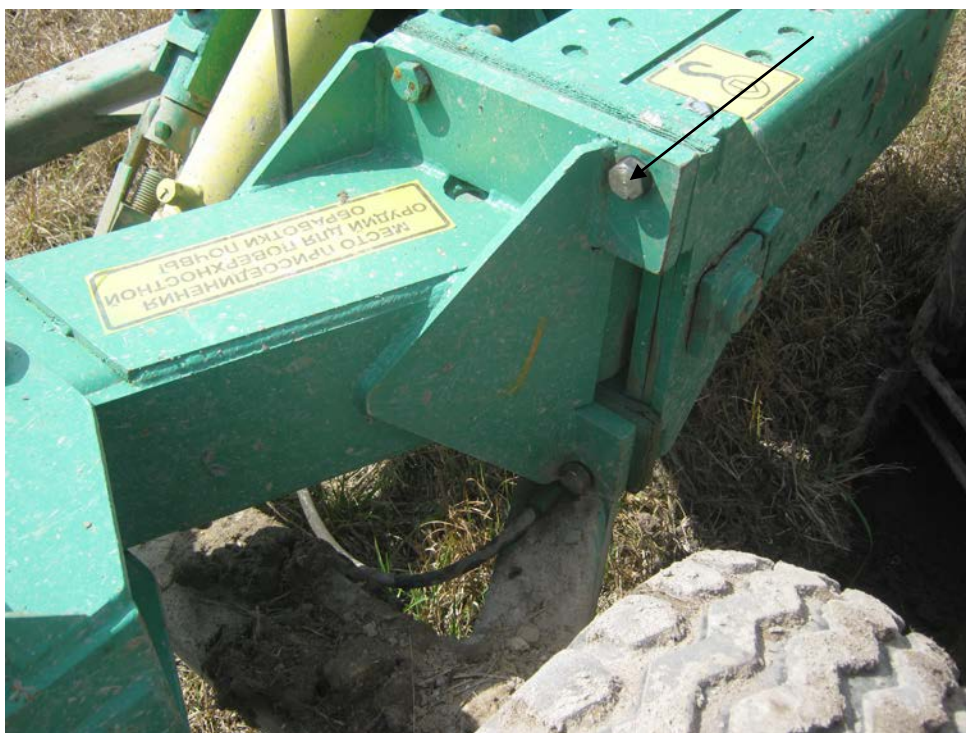
Рис. А.6 - Плуг оборотный ППО-8-40-01. Замена болта
