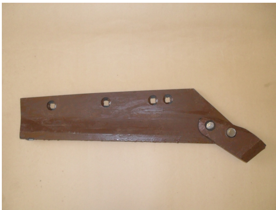
Эвольвентный трапецевидный лемех с наклонным долотом (в сборе с лицевой стороны)
