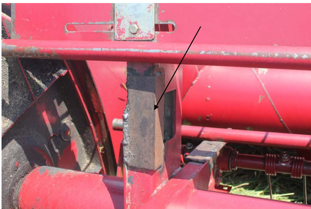
Рисунок 3 - Комбайн самоходный кормоуборочный КСК-600. Электросварка держателей. Вид после устранения отказа
