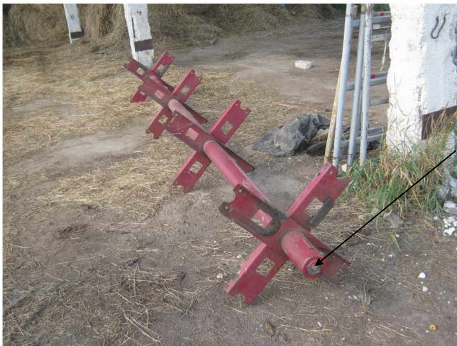
Рисунок 4 - Комбайн самоходный кормоуборочный КСК-600. Срез шлицев хвостовика вала мотовила
