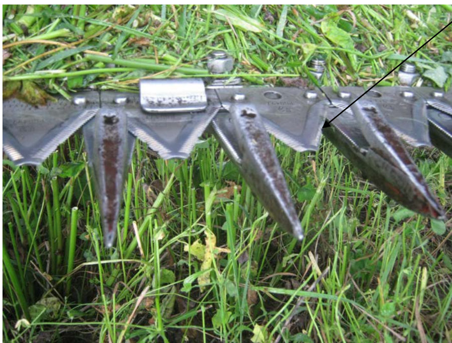
Рисунок 5 - Комбайн самоходный кормоуборочный КСК-600. Выкрашивание режущей кромки сегментов режущего аппарата
