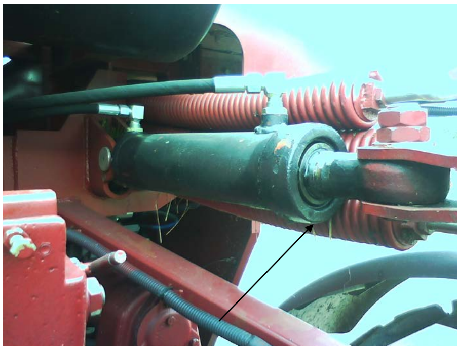
Рисунок 2 - Комбайн самоходный кормоуборочный КСК-600. Каплеобразование масла через манжету штока гидроцилиндра адаптеров
