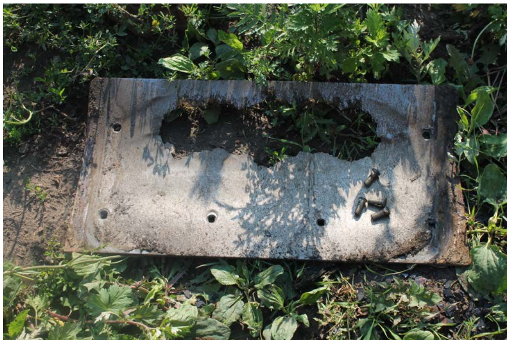
Рисунок 2 - Комплекс кормоуборочный высокопроизводительный КВК-800-36. Протирание поддона ускорителя подачи
