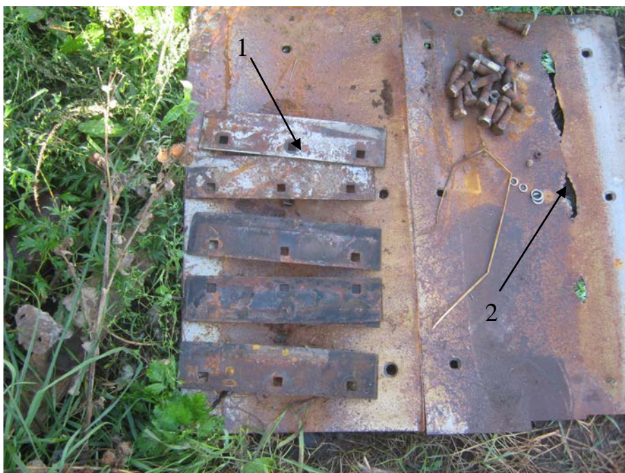
Рисунок 7- Комплекс кормоуборочный высокопроизводительный КВК-800-36. 1 - износ лопастей ускорителя выброса, 2 - протирание поддона измельчающего барабана
