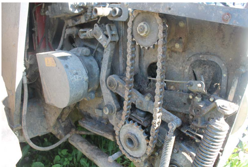
Рисунок 3 - Комплекс кормоуборочный высокопроизводительный КВК-800-36. Вытягивание цепи привода питающего аппарата (вид после устранения)
