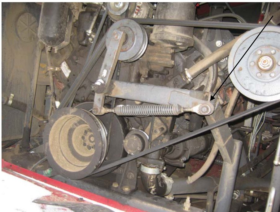
Рисунок 6 - Комплекс кормоуборочный высокопроизводительный КВК-800-36. Отрыв по сварке кронштейна натяжного ролика. Вид после устранения
