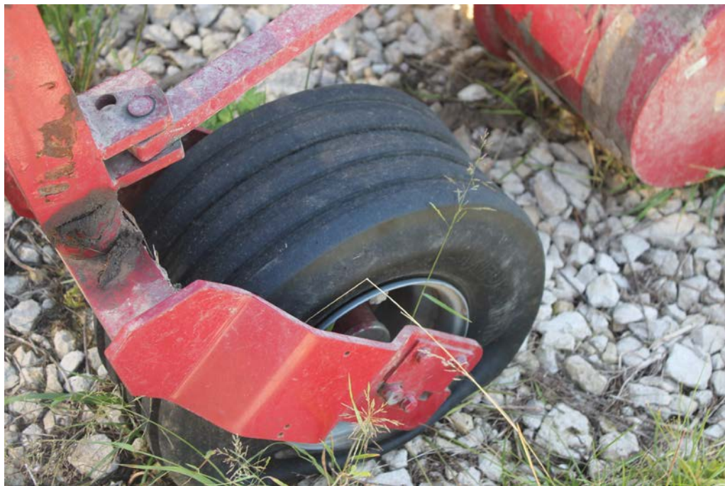
Рисунок 4 - Комплекс кормоуборочный высокопроизводительный КВК-800-36. Подборщик. Потеря герметичности шины опорного колеса
