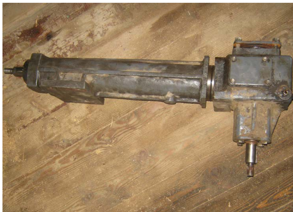
Рисунок 5 - Комплекс кормоуборочный высокопроизводительный КВК-800-36. Конический редуктор привода вентилятора
