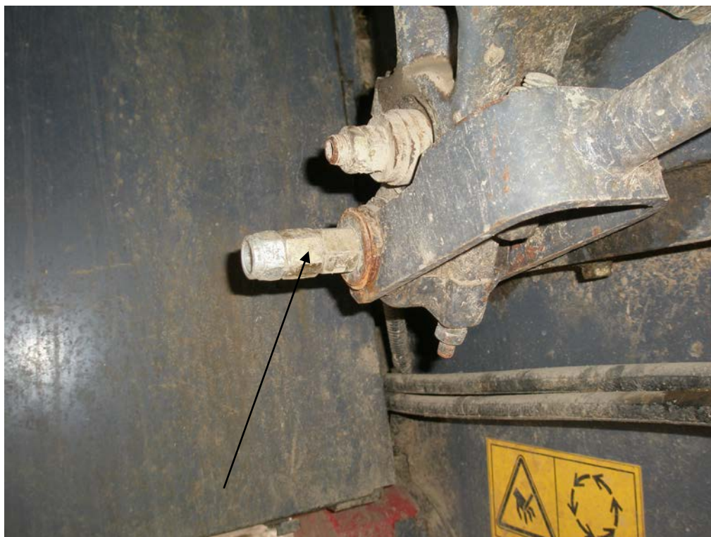
Рисунок №2 - Комбайн зерноуборочный самоходный КЗС 1218 Вид по- сле восстановления, изготовление пальца, с установкой контргаяк
