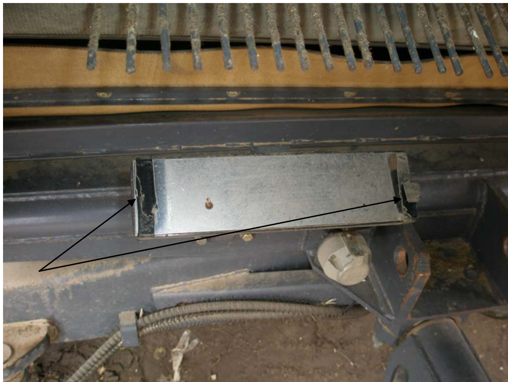
Рисунок №5- Комбайн зерноуборочный самоходный КЗС 1218 Крепление датчиков изоляционной лентой
