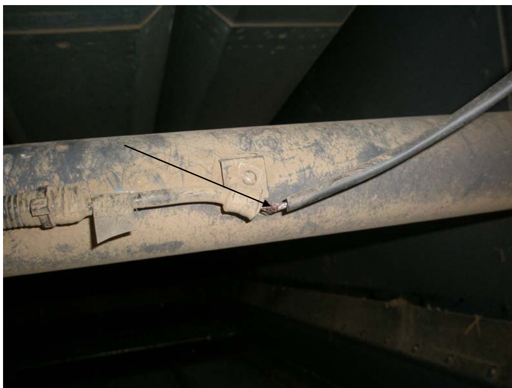
Рисунок №6- Комбайн зерноуборочный самоходный КЗС 1218 Замыкание проводов фары освещения решёт. Разрыв защиты проводов
