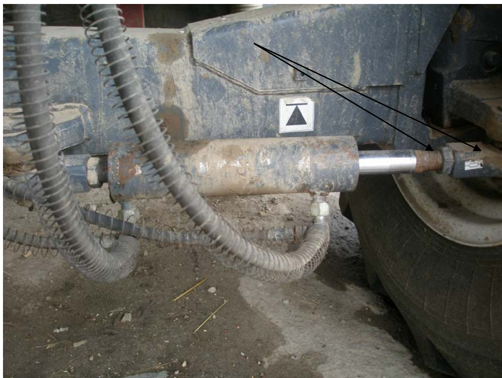
Рисунок №4- Комбайн зерноуборочный самоходный КЗС 1218 Вид после восстановления, рассоединение штока гидроцилиндра рулевой тяги от цапфы поворотного кулака
