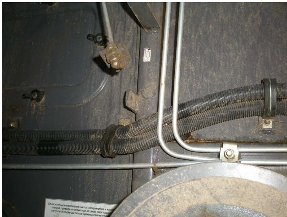
Рисунок №3- Комбайн зерноуборочный самоходный КЗС 1218 Излом кронштейна маслѐнки по сгибу
