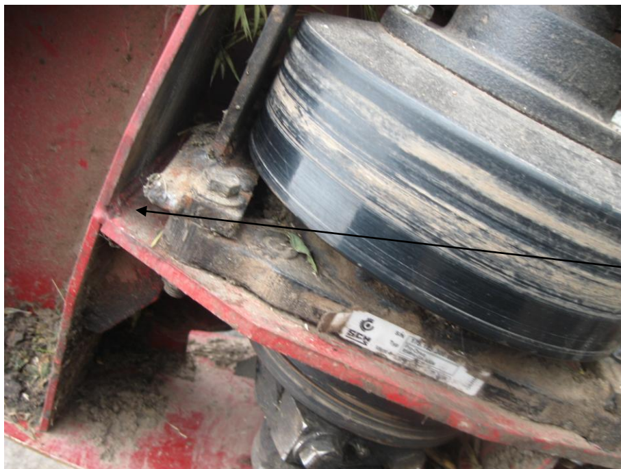
Рисунок А.2 – Косилка самоходная универсальная КСУ-1.00. Отрыв уха крепления гидромотора привода ножей. Вид после восстановления
