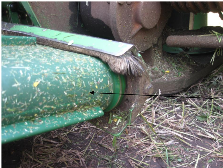
Рисунок 1 - Комплекс косилок Perfekt CUT KDF 300 S+KDD861ST. Истирание полотна транспортёра
