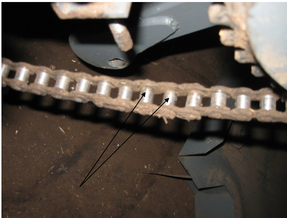
Рисунок 1– Комбайн зерноуборочный самоходный РСМ-142 «ACROS»-580. Растяжение и разрыв цепи привода наклонной камеры. Вид после устранения отказа.
