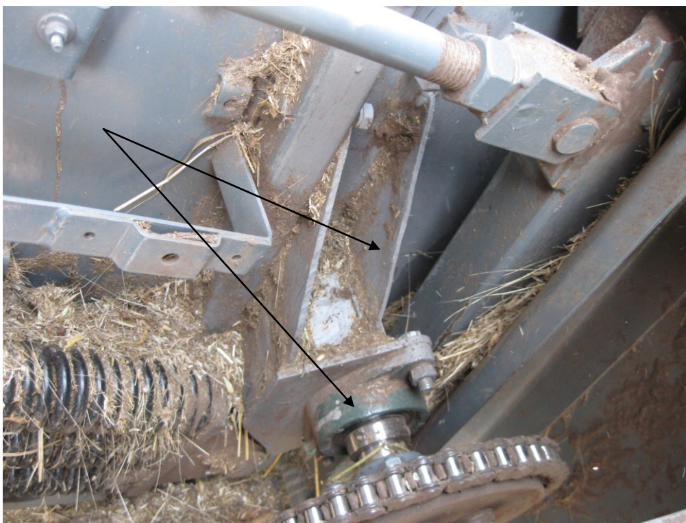
Рисунок 2 – Комбайн зерноуборочный самоходный РСМ-142 «ACROS»-580. Усиление кронштейна крепления нижнего вала транспортера наклонной камеры установкой косынок и замена корпуса подшипника. Вид после устранения отказа.
